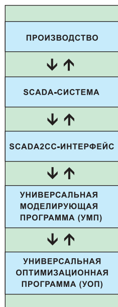
Рис. 1. Оптимизация химических производств с использованием УМП CHEMCAD в режиме реального времени — режиме онлайн
